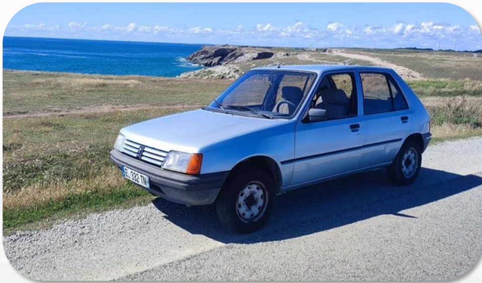
Peugeot 205 (1998) Injection indirecte monopoint 1.1 Litres 6,3l/100KM 60 chevaux
